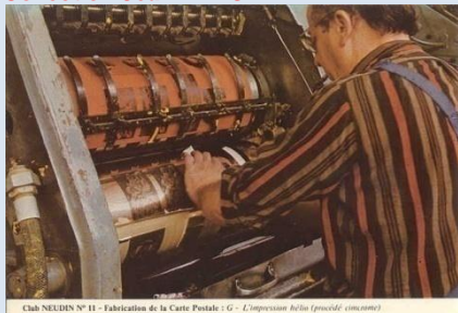
Club NEUDIN N°11 - Fabrication de la Carte Postale : G - L'impression héliographique (procédé cimchrome)
